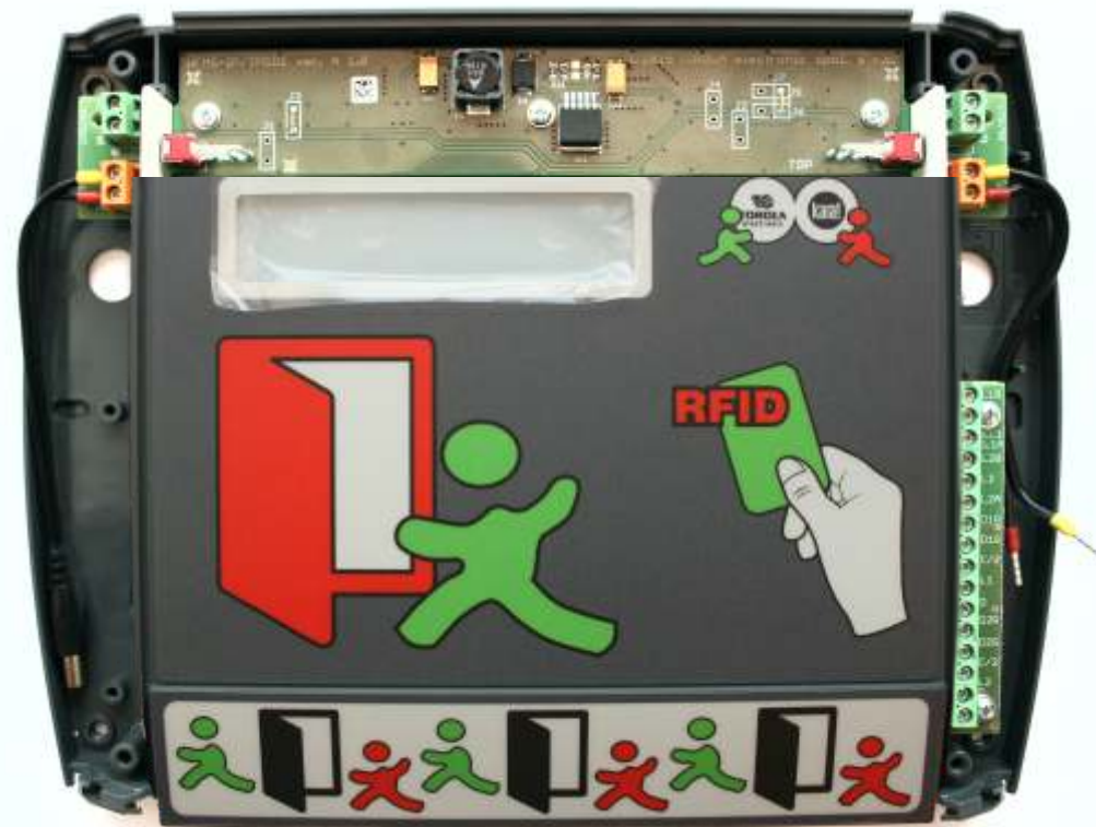
Obr. Řez terminálem se zobrazením přechodového modulu
